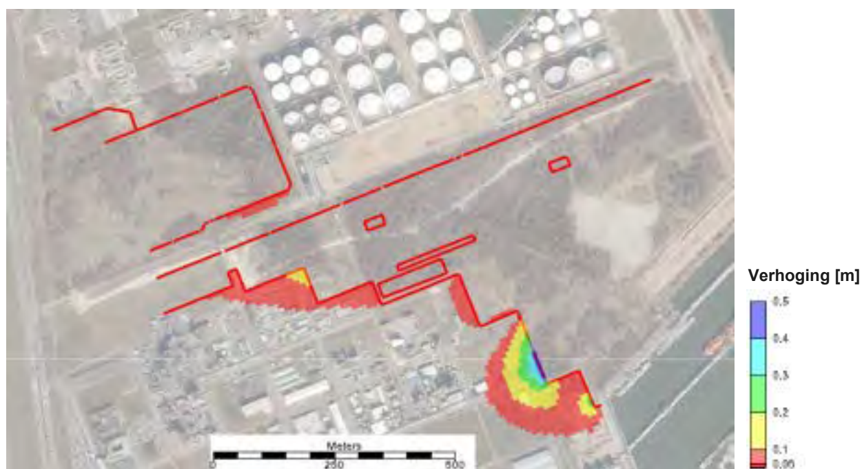
Figuur 9-19 : Tijdelijke verhoging van de grondwatertafel veroorzaakt door de aanleg van de damwand.
