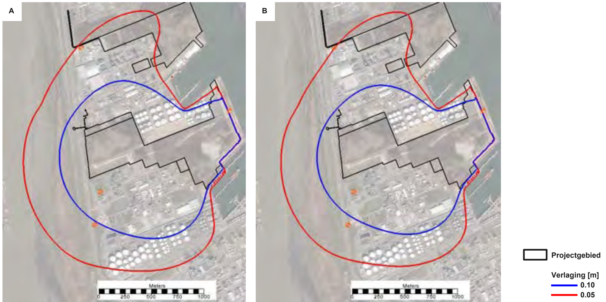
Figuur 9-21: Grondwaterverlaging in de tweede aquifer (onder de polderklei met aanduiding van de grondwaterwinningen in de omgeving) – in het scenario zonder preventieve maatregelen (A) (links) en het damwandscenario (B) (rechts)
