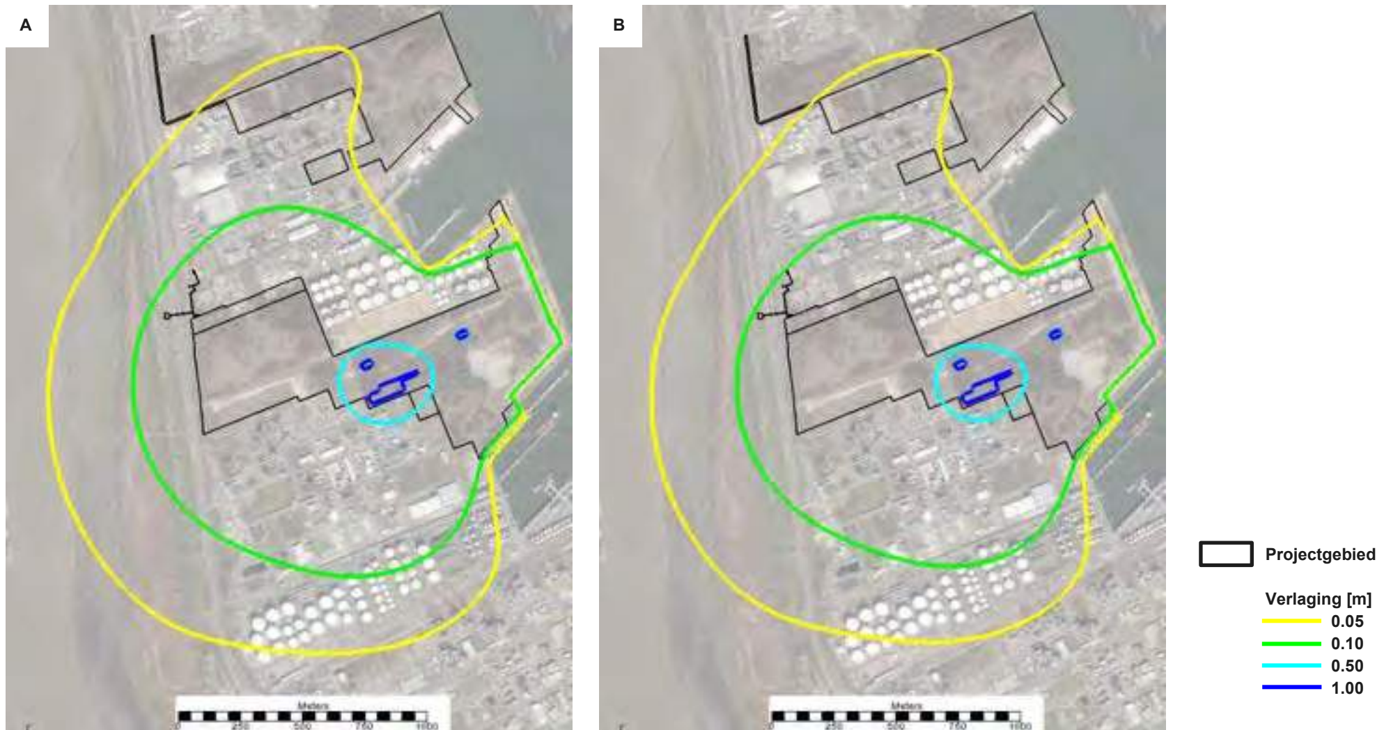
Figuur 9-18 : Maximaal berekende grondwaterverlaging (m) in de 2e aquifer voor a) maximaal scenario (bemaling zonder maatregelen) (links), b) damwandscenario: bemaling met preventieve maatregelen, nl. het voorzien van damwanden rondom de constructiezone
